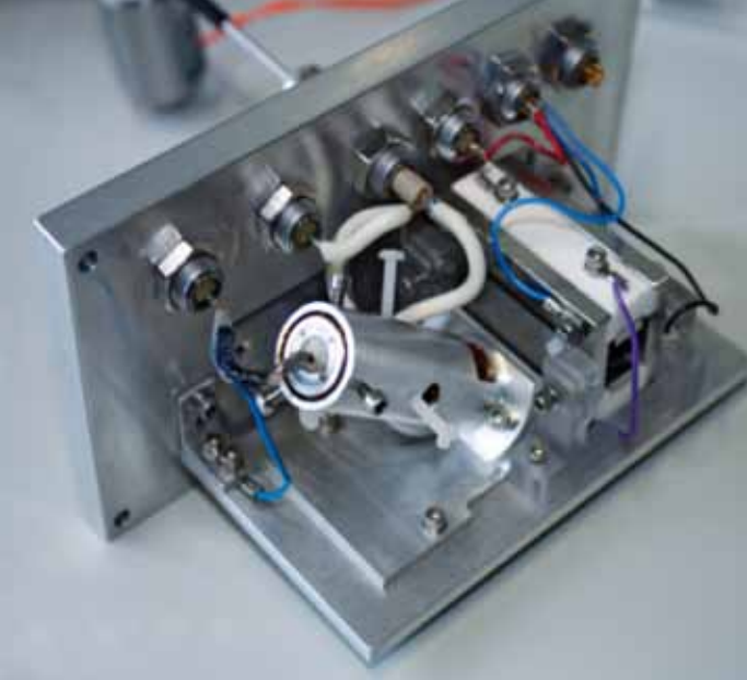
Aufbau eines miniaturisierten Einlasssystems eines Massenspektrometers für die Vor-Ort-Analyse
