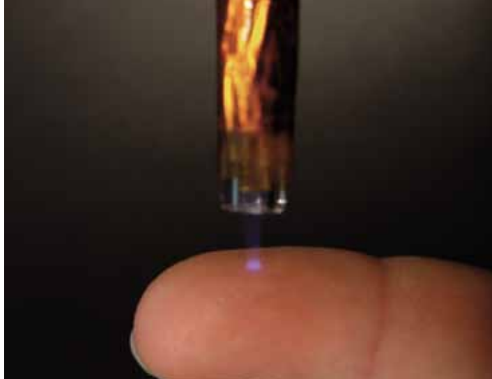
Sonde einer Helium-Niedertemperaturplasma-Ionenquelle für den Nachweis von Substanzen auf beliebigen Oberflächen. Gut erkennbar ist der blau leuchtende Strahl des Plasmas, das mit seiner Energie die nachzuweisenden Moleküle von der Haut ablöst und ihnen eine elektrische Ladung gibt, dabei aber für die Person völlig schmerzfrei und unschädlich ist.
