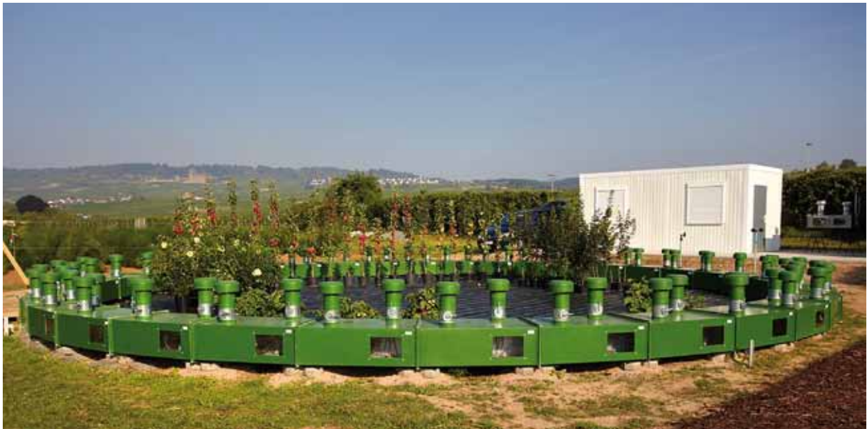
Bild zeigt einen fertig gestellten Ring zur CO 2 -Begasung von Gemüse
